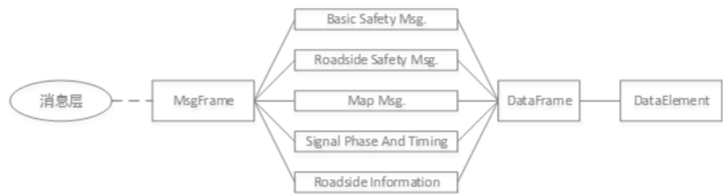
图1 基于LTE的车联网无线通信技术消息层数据集构成
